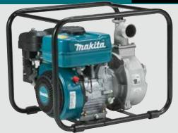
169 c.c Máx. volumen de agua 31.200 L/h Altura máx. de succión 8,0 m Altura de elevación total 32,0 m 24,9 Kg
